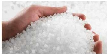
Extruder 1: Re-Granulat aus PE-Abfall
